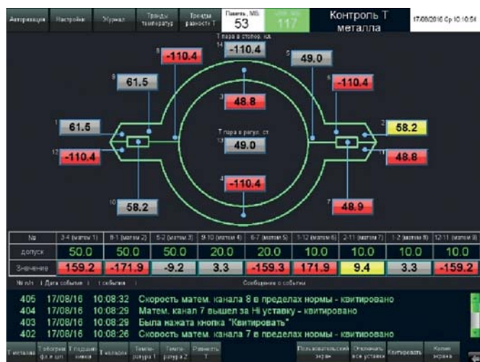
Рис. 1. Экран «Контроль температуры металла» в ПТК температурного контроля турбины
